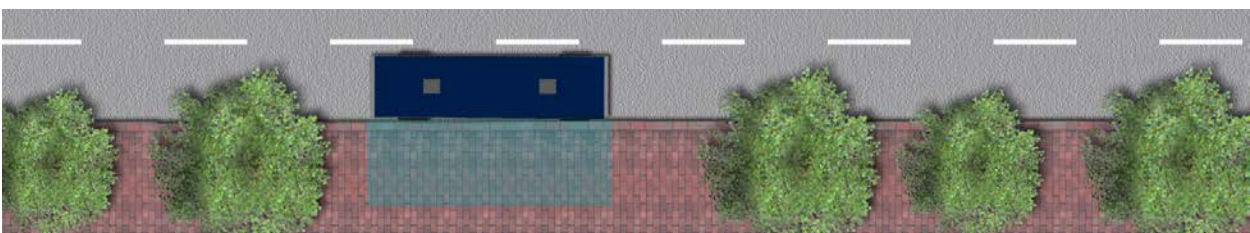
Abbildung 2: Schematische Darstellung einer Haltestelle am Fahrbahnrand ohne Parken am Fahrbahnrand
